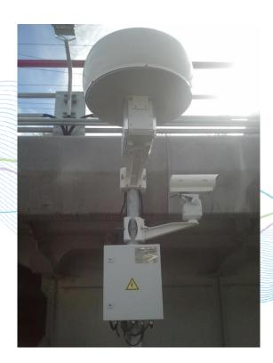
Поставка 59 Радарно-оптических комплексов на основе РЛС Orwell-R и Тепловизионных локаторов кругового обзора «Филин» для обеспечения безопасности совмещенной (автомобильной и железной) дороги Адлер — горноклиматический курорт «Альпика-Сервис».
