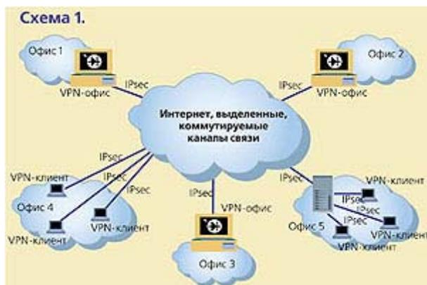
Суть предлагаемого решения (схема 1) в построении периметра защищенной корпоративной сети на основе технологии VPN. Решение базируется на применении ПО VPN-Офис для сетевой защиты компьютеров сети каждого офиса и защиты от несанкционированного доступа из внешних сетей. Для защиты трафика между центральным офисом и филиалами на шлюз каждой локальной сети устанавливается VPN-Офис, скрывающий внутреннюю топологию
